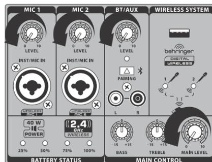
**4** Connectez les micros analogiques, les instruments et/ou les câbles RCA à leurs embases respectives.
